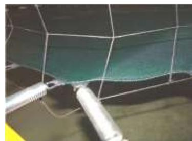
Снизу сетку цеплять только за угловые пружины
